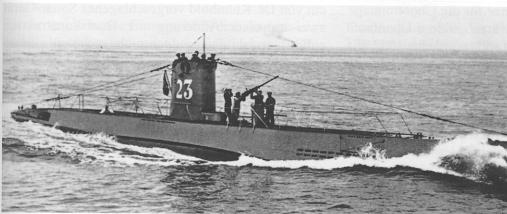
Flak-Exerzieren auf U 23. Etwa 1937/38 erhielten fast alle Typ II-Boote das sogen. Fla-MG C/30, das bei Nichtgebrauch in einer Tonne auf dem Vorschiff verstaut war. Zur Herstellung der Feuerbereitschaft wurden nach Abnehmen des Deckels die Säule hochgefahren, die Wiege hochgeklappt und der Lauf eingelegt.
