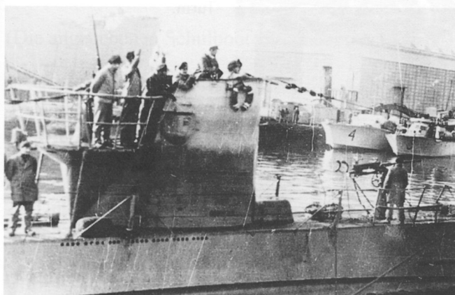
U 20 mit angebautem ‚Wintergarten‘ an die Brücke läuft im Sommer 1943 in Konstanz ein. Das Uboot besitzt jetzt je eine 2 cm-Flak in Einzellauffette auf der Brücke und dem Vorschiff.
