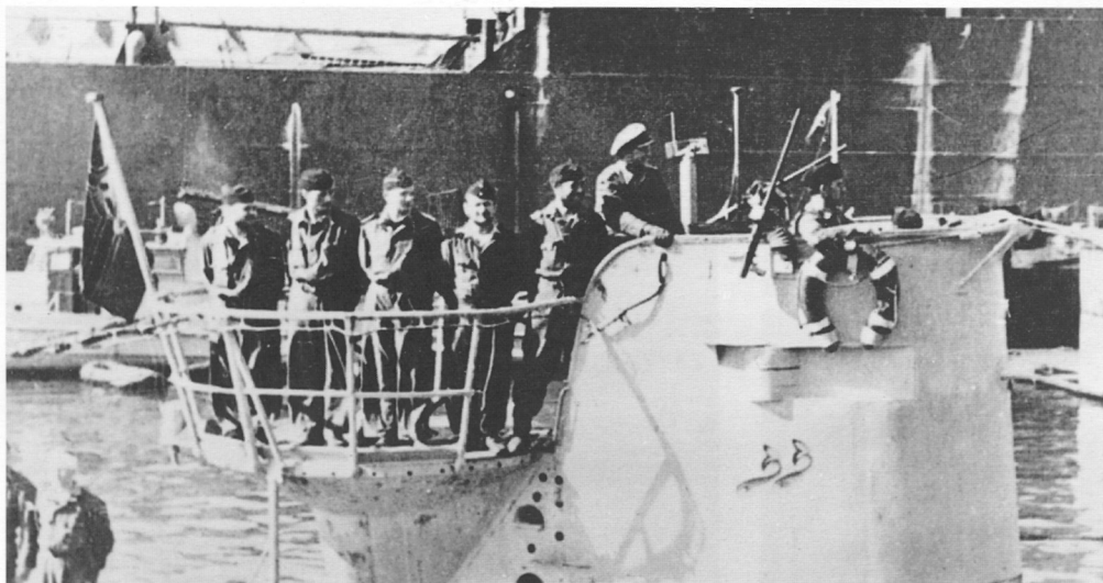
U 9 mit vergrößerter Brücke und einer 2 cm-Zwillingsflak 38 nach dem Einlaufen von einer Feindfahrt im Frühjahr 1944.
