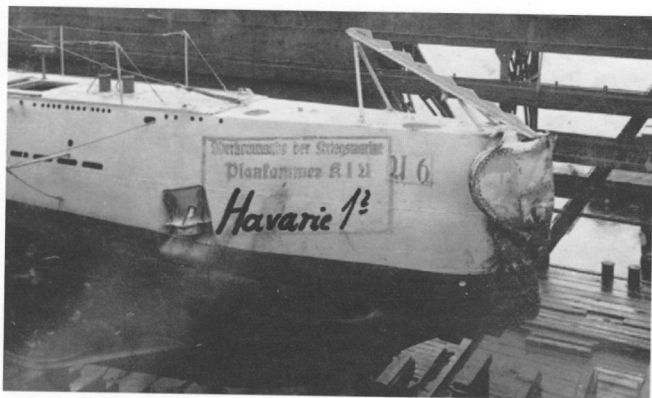
Vorschiff von U 6. Das Boot befindet sich nach einer Havarie im Mai 1937 im Dock. Deutlich ist die umgeknickte Bugspitze zu erkennen. Links auf dem Vorschiff ist die Drehbasis eines passiven Ortungsgerätes mit magnetostruktiven Empfängern (MDB) angeordnet.
