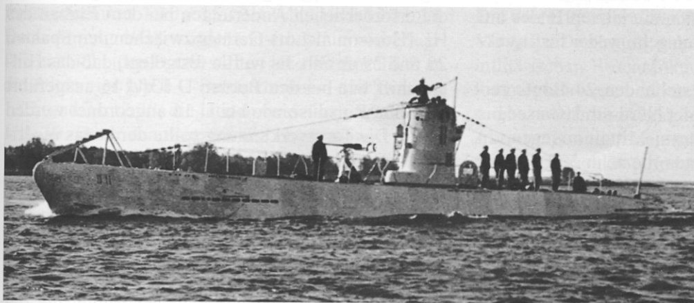
U 11 mit der 2 cm C/30 auf Sockellaffette. Dieses Uboot bekam diese Ausführung der 2 cm-Flak, die für die Uboote des Typs II C vorgesehen war, zur Erprobung eingebaut.
