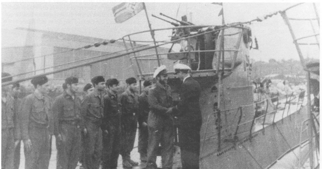
U 9 mit vergrößerter Brücke und einer 2 cm-Zwillingsflak 38 nach dem Einlaufen von einer Feindfahrt im Frühjahr 1944.
