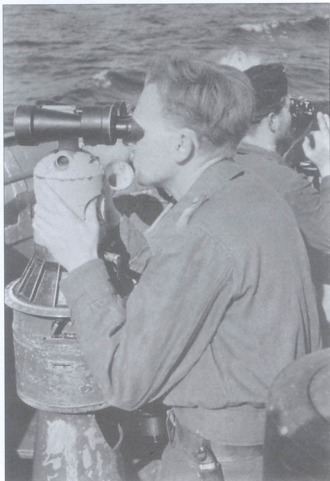
U 106 (Typ IX B), jeden z uczestników wachty podczas obserwacji za pomocą celownika dla nawodnych strzelających torped typu UDF 7x50. • A member of a watch on U 106 observing the horizon through a UDF 7x50 sight used for surface firing of torpedoes.
