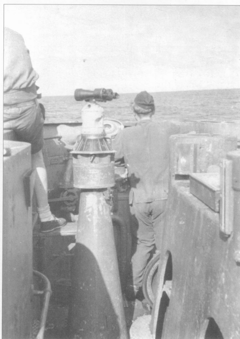
U 106 (Typ IX B), jeden z uczestników wachty podczas obserwacji za pomocą celownika dla nawodnych strzelań torpedowych typu UDF 7x50. • A member of a watch on U 106 observing the horizon through a UDF 7x50 sight used for surface firing of torpedoes.
