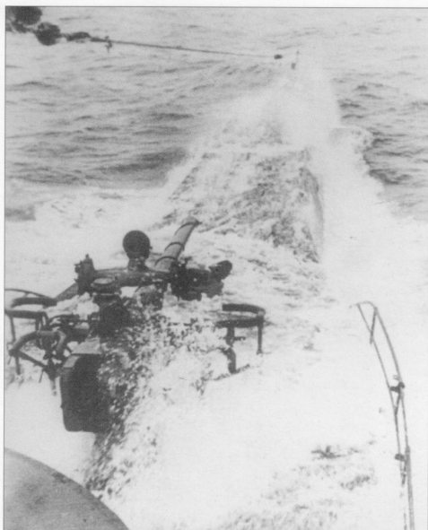
Uboot Typ VII C, w początkowym okresie II WS wszystkie jednostki uzbrojone były w działo typu 8,8 cm SK C/35. • Type VII C U-Boat. During the initial stages of WW II all U-Boats were armed with the 8.8 cm SK C/35 gun.
