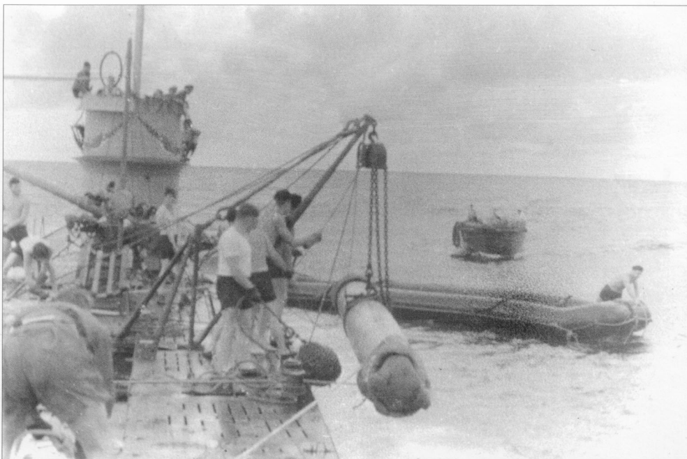
U 106 (Typ IX B) , podczas operacji załadunku na pokład otrzymanych od zaopatrzeniowca dodatkowych torped. U 106 (Type IX B) being re-supplied with torpedoes by a supply ship.
