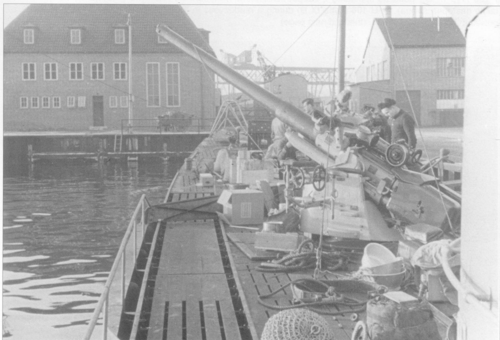
U-booty Typu IX B były początkowo uzbrojone w widoczne na zdjęciu działo 10,5 cm SK C/35 oraz działka przeciwlotnicze 1 x 3,7 cm, 1 x 2 cm. • U-Boats of Type IX B were initially armed with a 10.5 cm SK C/35 gun and one each of the 3.7 cm and 2 cm guns.
