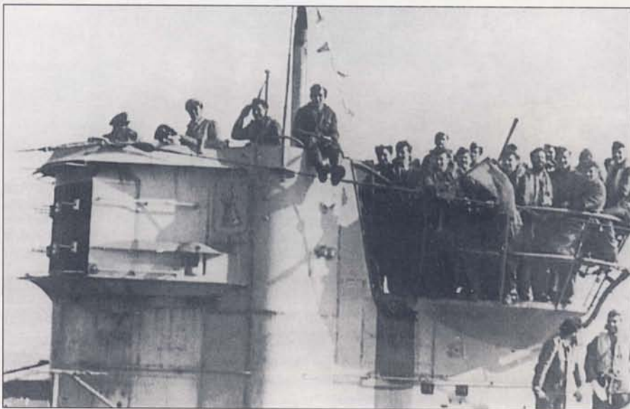
U-628 типа VIIС была оснащена системой «Метокс», которая обнаруживала работу радиолокаторов противника, также на лодке смонтирована РЛС FuMo-29 антенны этой РЛС обычно закрывались колпаками.
