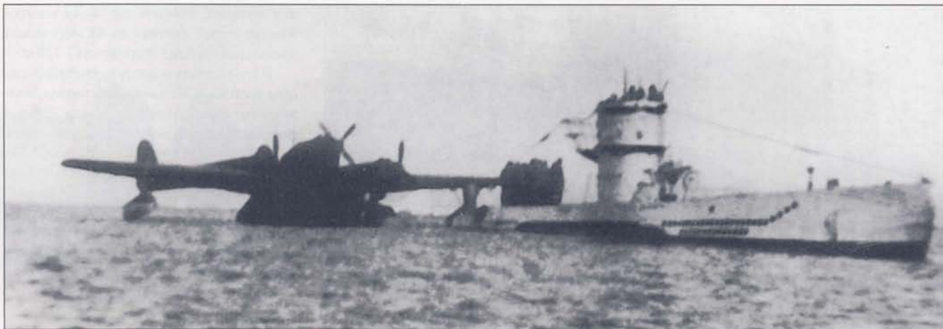
Лодка типа VII C заправляет топливом в море гидросамолет BV-138, 14 августа 1942 г. Такие самолеты часто взаимодействовали с У-ботами, обеспечивая их информацией о конвоях союзников. Прием топлива самолетами от лодок в море позволял увеличить время патрулирования гидропланов. Субмариной U-255 командовал капитан-лейтенант Рейнхарт Рихе. Он принял лодку 29 ноября 1941 г. и принимал участие в разгроме конвоя PQ-17, 17 марта 1943 г. Рихе был удостоен Рыцарского креста, а вскоре переведен на берег в штаб У-бот командования «Норд».
