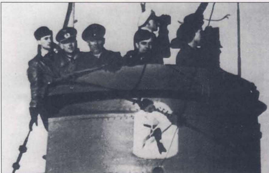
U-423 типа VIIС, двухцветная окраска рубки уникальна. На рубке изображена эмблема субмарины. Двухцветный камуфляж серьезно затруднял обнаружение субмарин в надводном положении кораблям и самолетами противника.
