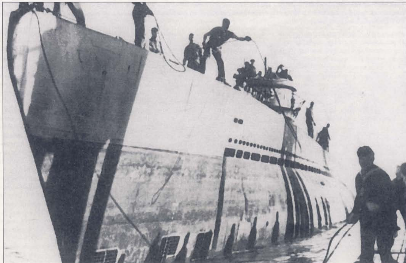
U-464 типа XIVА, «дойная корова». С пустыми трюмами борт субмарины высоко поднимается над водой. Всего в годы войны было построено десять лодок типа XIVА, три из них погибли в 1943 г. всего за шесть дней. Главной проблемой при снабжении оставалась необходимость длительного пребывания на поверхности в ходе передачи топлива, торпед, провизии и т.д. Закрытие Великой Атлантической брешии четырехмоторными патрульными самолетами союзников сделало длительное нахождение У-ботов на поверхности невозможным.
