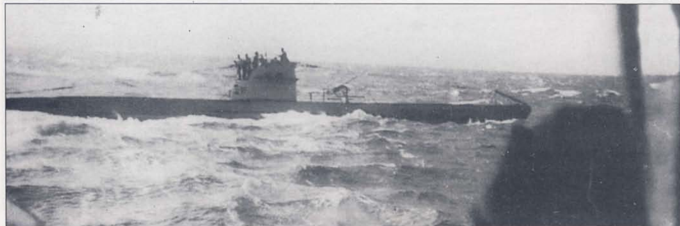
U-60 - субмарина типа IIC, снимок сделан в море с борта другого У-бота. Серая окраска и небольшие размеры снижали заметность У-ботов в надводном положении. Субмарина U-60 вооружена 20-мм зенитным автоматом.
