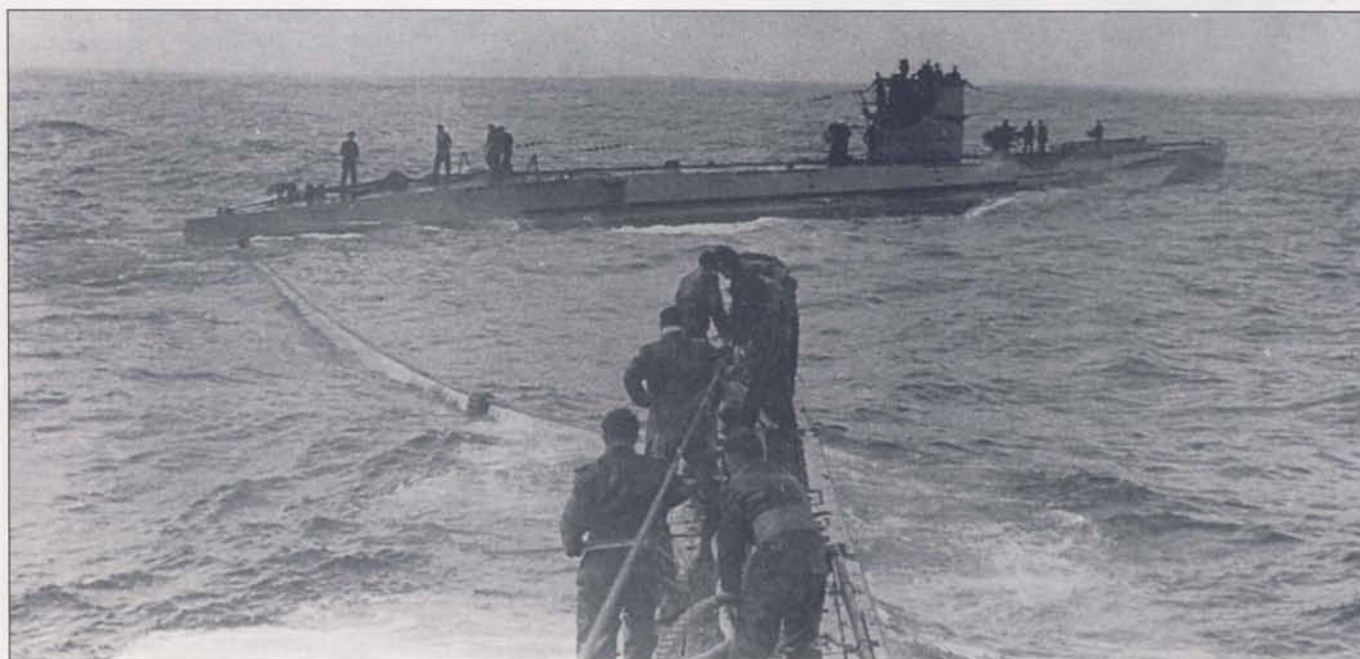
Прием топлива субмариной U-116 с субмарины U-406. Пополнение расходуемых материалов в открытом море значительно увеличивало автономность У-ботов.
