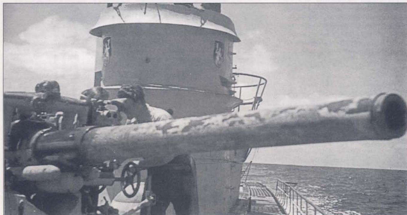
Расчет 88-мм орудия субмарины U-172 готов открыть огонь по противнику. Наводчик смотрит в прицел, установленный слева от казенника орудия. Заряжающий дослал снаряд. Орудия являлись эффективным оружием, но использовали пушки редко. Команды предпочитали скорострельные зенитки.
