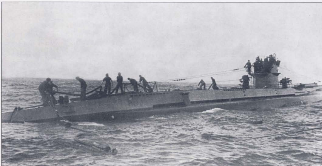
Команда готовит шланги для приема топлива в море. На снимке - U-116. Дозаправка в море представляла собой исключительно опасную работу, особенно при волнении океана. Голыми руками - скользкий шланг да на мокрой палубе.
