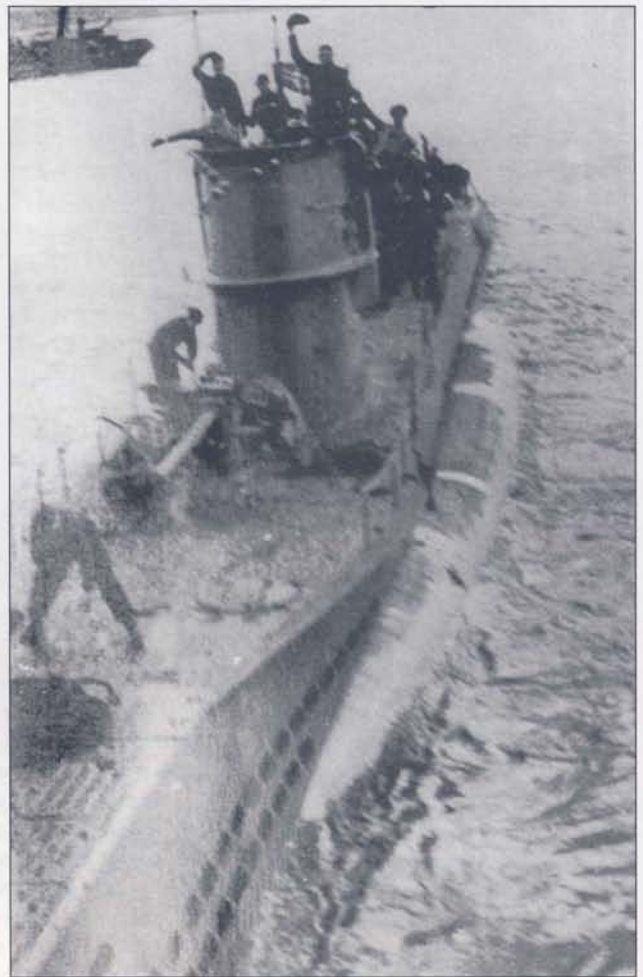
U-52 - субмарина типа VIIВ - вернулась из боевого похода. В начале войны У-ботом командовал капитан-лейтенант Вольфганг Бартен, затем субмарину принял капитан-лейтенант Отто Залман. В районе оружейной платформы палуба лодки расширена для удобства работы артиллерийского расчета.
