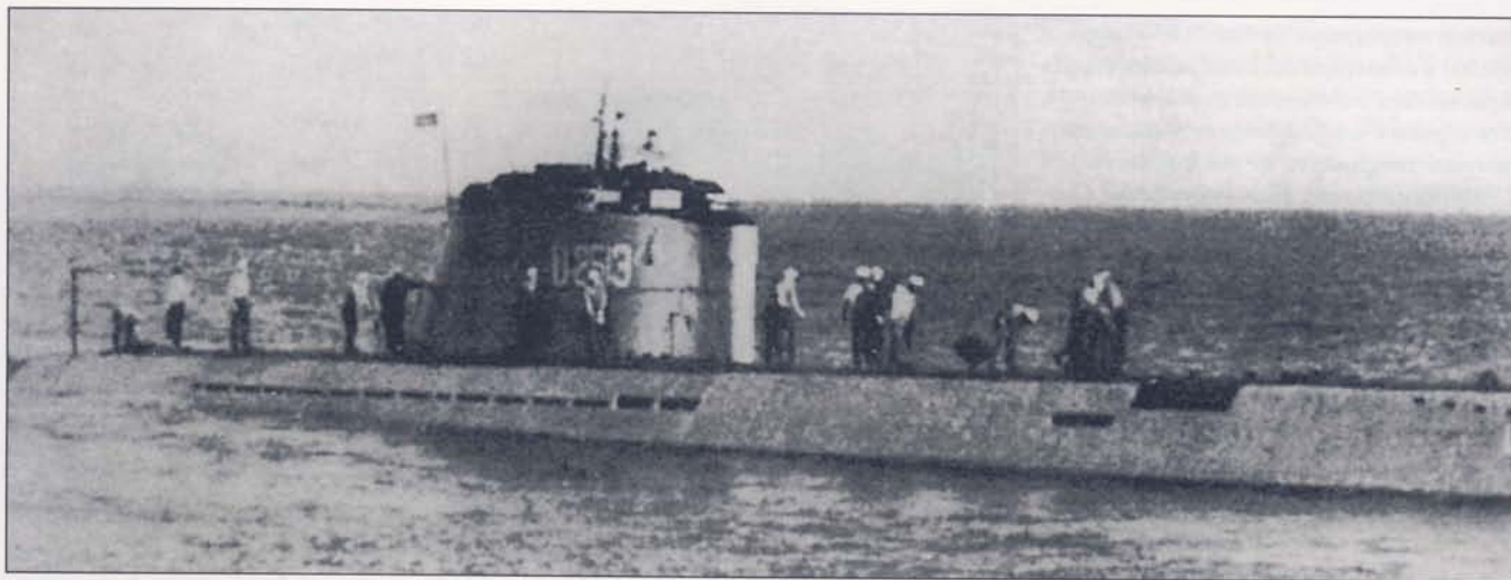
U-2513 - субмарина типа IXD - в крейсерстве у берегов США. Эти лодки предназначались для дальних походов и снабжения находящихся на боевом патрулировании более мелких У-ботов. Тип IXD представлял собой увеличенную лодку типа IXC с демонтированными для увеличения емкости грузовых отсеков торпедными аппаратами, также была снята в тех же целях часть аккумуляторных батарей. На лодках IXD стояли более мощные, чем на лодках IXC, дизеля, которые обеспечивали большую полную скорость надводного хода. У экипажей лодки IXD получили прозвище «Überseekuh» - заморская корова.
