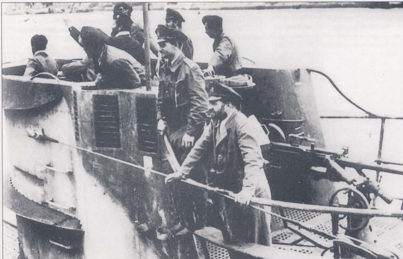
Рубка субмарины U-109 типа IXB. Моряки смотрят как их корабль ставят к стенке пирса. У-бот вернулся из дальнего плавания. Просматривается разрушающий, светло-/темно-серый камуфляж рубки. На рубочной платформе установлен 20-мм зенитный автомат. Лодкой U-109 командовал корветтенкапитан Ханс-Георг Фишер.
