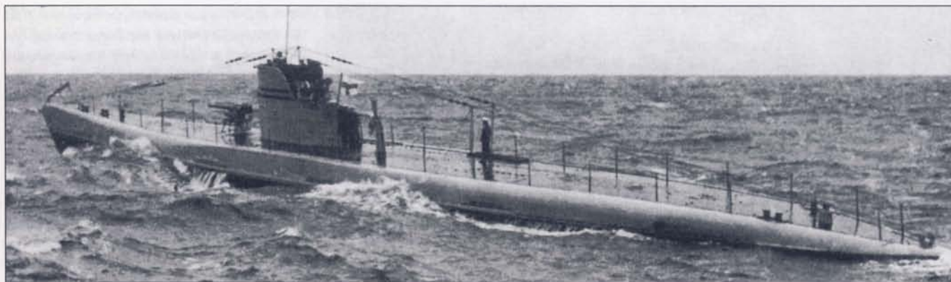
В межвоенный период, 20-е - 30-е годы, германские конструкторы подводных кораблей старались сохранить накопленный опыт и развить путем строительства подводных лодок для третьих стран. Субмарина «Саукко», построенная по заказу Финляндии - как раз из таких кораблей. Лодка предназначена для операций в прибрежных водах и очень похожа на более поздние субмарины VII серии.
